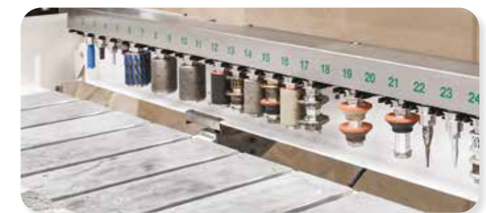
Aligned tools store with inox stainless steel cover. Magazzino utensili lineare con coperchio in acciaio inox.
