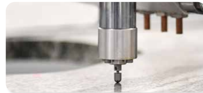
Electronic feeler for automatic measuring of the work-piece thickness. Sonda elettronica per la misurazione automatica dello spessore del pezzo da lavorare.
