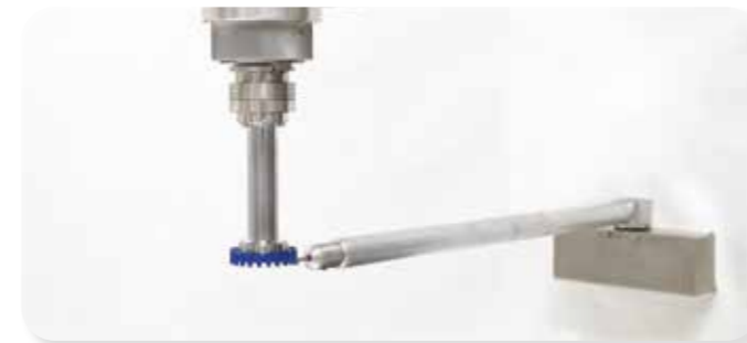
Electronic presetting feeler for the control of the tool diameter and length. Sonda elettronica per il controllo del diametro e della lunghezza dell'utensile.
