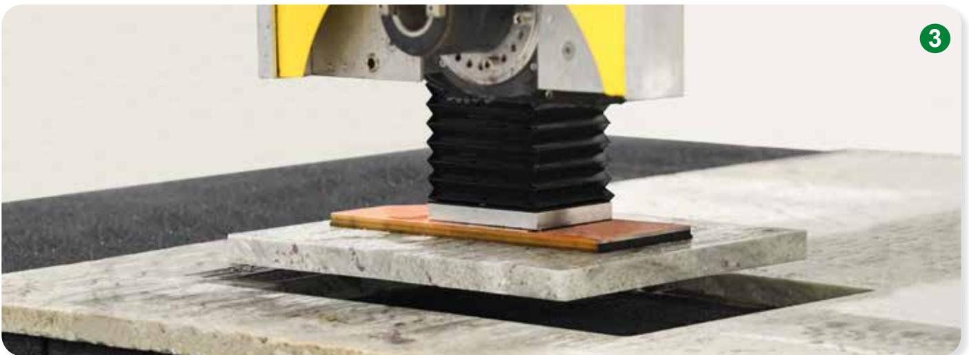
Removal of waste material Rimozione del materiale di scarto
